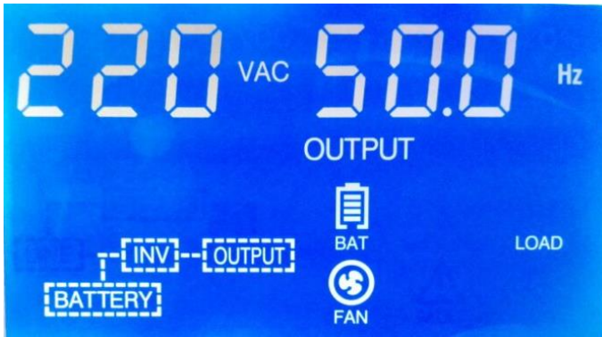
显示当前输出电压220Vac
