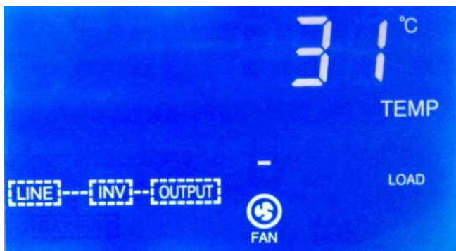
显示当前散热器温度31°C
