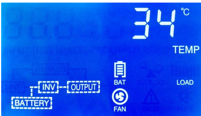
显示机器内散热器温度34℃
