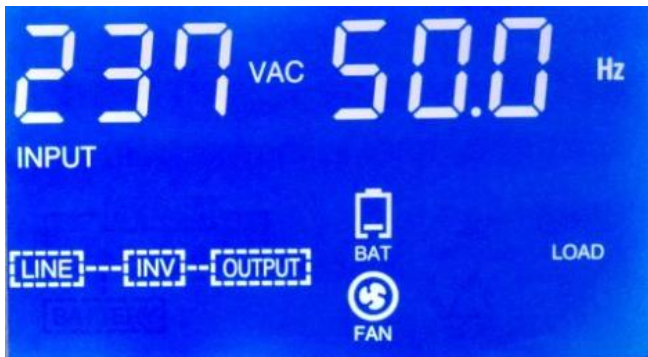
显示市电输入电压237Vac
