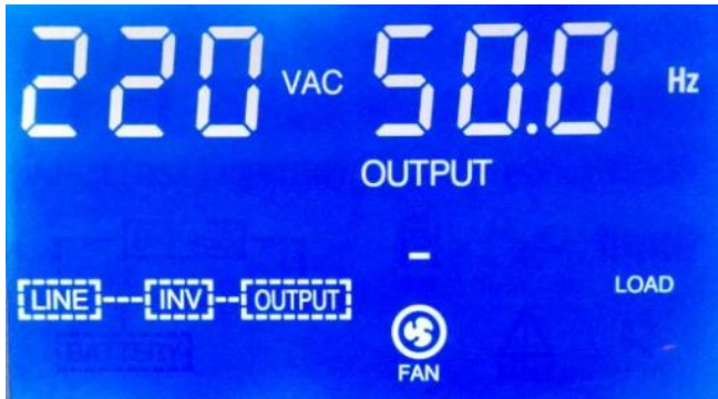
显示当前输出电压220Vac
